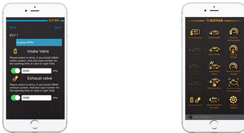
Il kit Arma permette di pilotare due valvole alla volta, settando due diversi regimi di giri. Questo permette di avere aspirazione e scarico entrambi con valvola, o applicazioni di scarico a doppio stage (3 livelli di rumorosità)
